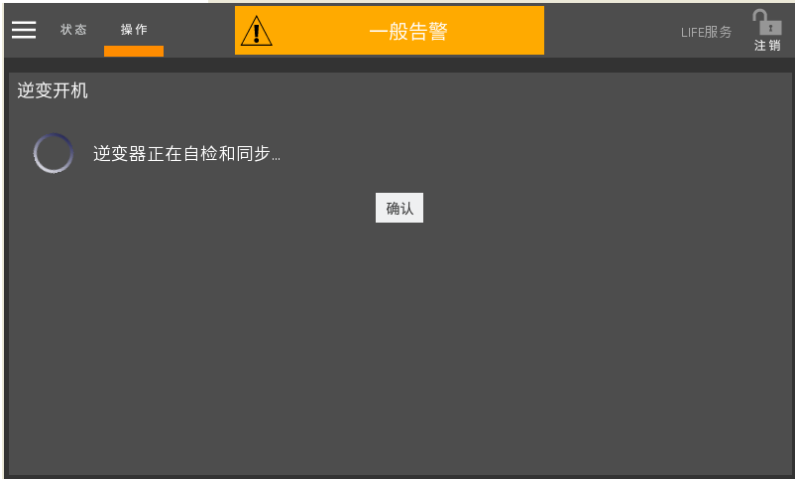
图5-3 逆变器自检和同步
