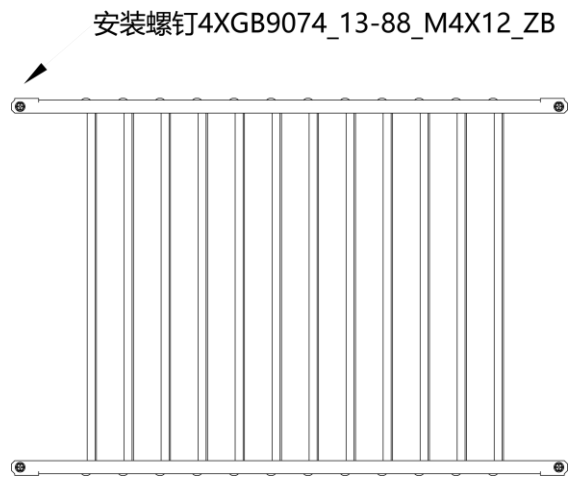
图3-14 导风格栅螺钉位置
