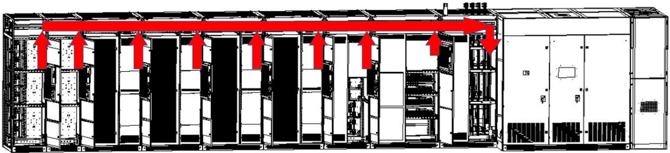
图4-7 低压侧通讯线缆敷设路径示意图
