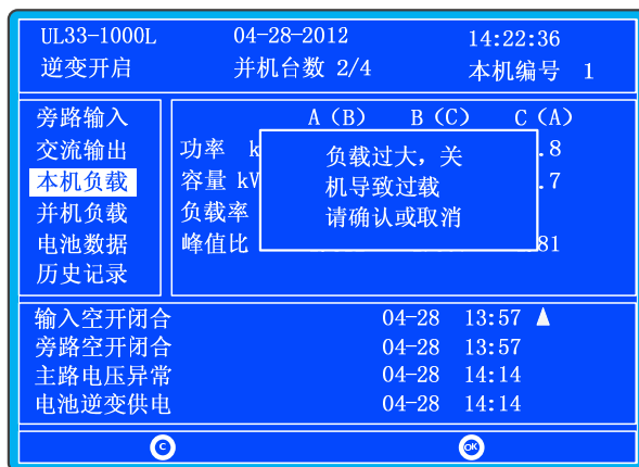
图5-38 扩容并机系统关机导致过载提示窗
