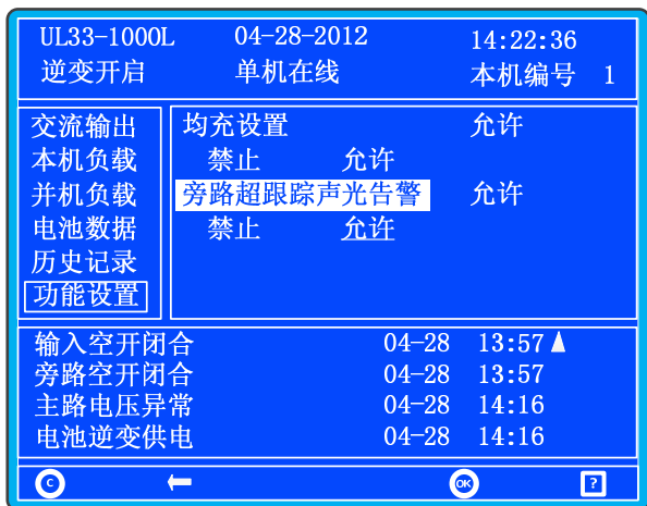
图5-35 旁路超跟踪声光告警设置显示屏
