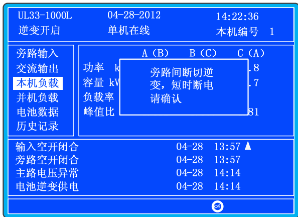
图5-36 旁路超限间断切换至逆变提示窗
