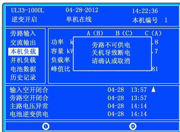
图5-37 旁路超限间断切换至旁路提示窗
