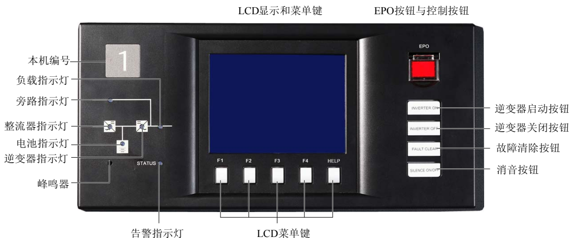
图5-2 显示控制面板功能划分示意图
