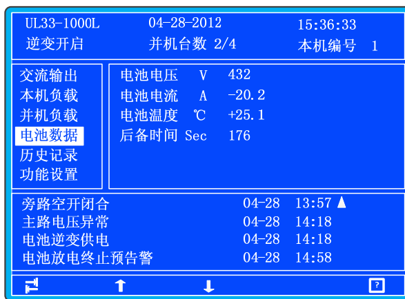
图5-17 电池放电到终止预告警状态系统显示屏
