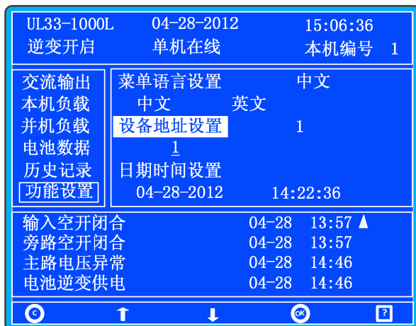
图5-22 设备地址设置显示屏
