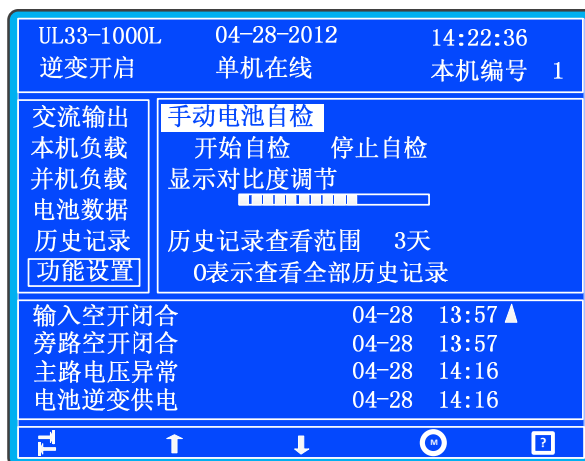
图5-31 手动电池自检显示屏
